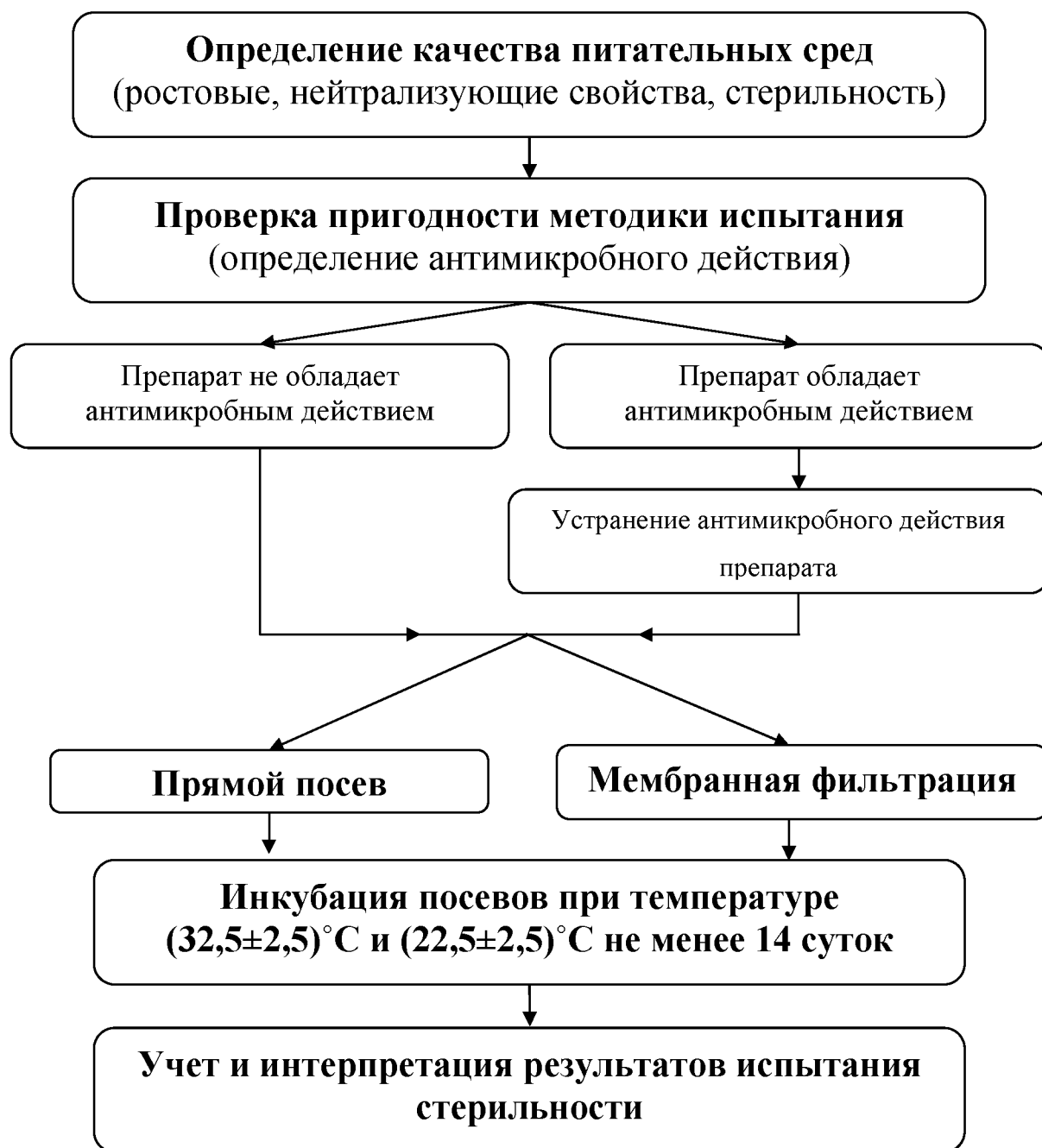
Рисунок 1 – Схема проведения испытания на стерильность
